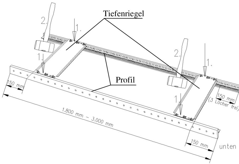
Der untere Tiefenriegel muss sich in einer Höhe von 150 mm über dem Boden (3 Löchungen frei lassen) befinden. Beim oberen Tiefenriegel halten Sie ebenfalls einen Abstand von 150 mm (3 Löcher frei lassen) ein. Die 300 mm tiefen Regale sind für Ihre Felgen und die 400 mm tiefen Regale sind für Ihre Reifen gedacht.
