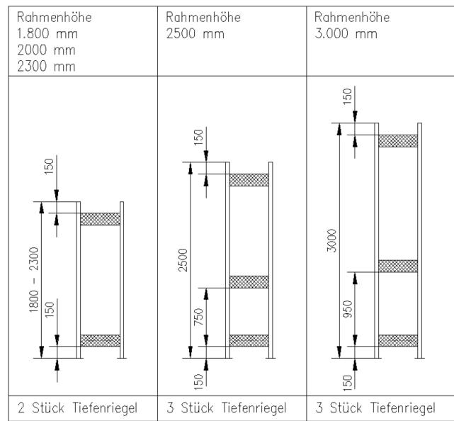
3. Nach dem Einschlagen der Tiefenriegel müssen Sie diese sichern. Zu diesem Zweck werden die Sicherungslaschen mit einem Schraubenzieher ca. 1 mm eingedrückt.
